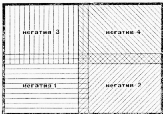
Рис. 72. Схема получения панорамных снимков при печатании
