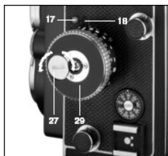
Питание системы TTL-замера и системы замера экспозиции вспышки осуществляется с помощью литиевой батарейки напряжением 6 Вольт. Поверните лимб фокусировки (29) в положение «1 м». С помощью монеты выкрутите против часовой стрелки крышку отсека батарейки (27), которая расположена в центре лимба фокусировки (29). Установите батарейку в отсек (знаком «+» внутрь отсека) и закрутите крышку отсека. Используйте только батарейки, которые имеют соответствующую полярность.
