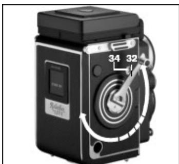
**Примечание:** Следите за тем, чтобы на рабочую поверхность пленки не попал свет. Для перемотки пленки на первый кадр плавно поверните ручку (32) до упора. Затем, поверните ручку (32), опять-таки до упора, но в обратном направлении. В результате этих действий, ручка перемотки пленки (32) будет зафиксирована в своем начальном положении, на счетчике кадров (34) появится цифра 1, а кнопка спуска затвора будет взведена. Теперь фотокамера готова к съемке первого кадра.
