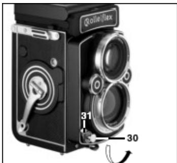
Переместите ручку блокировки (31) кнопки спуска затвора (30) из положения «блокирован» в положение «разблокирован» (отмечено зеленой точкой). У кнопки спуска затвора предусмотрено гнездо для спускового тросика, воспользовавшись которым фотограф может не опасаться встрижки камеры во время съемки.
