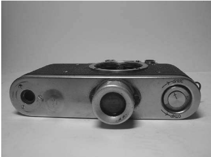
Оригинальный Зоркий - перископ с одетой нижней крышкой. Хорошо видна лупа, установленная в шахте.
