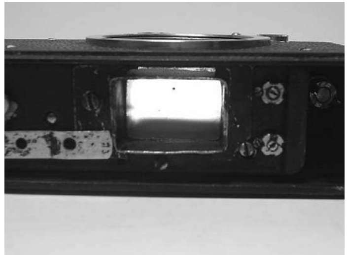
Вид снизу. Хорошо видно прорезанное в корпусе затвора отверстие, в котором установлен фокусирующий экран (матовое стекло)
