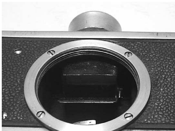
Вид через объективное кольцо. Хорошо видно шахту, матовое стекло и опущенное зеркало.
