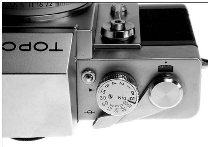
**Рис.13: Головка установки выдержек Топсон RE Super**
