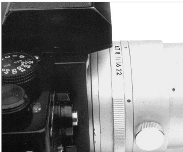
**Рис.22: Объективы старых модификаций не читаются видоискателем "СС"**
