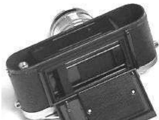
Камера Nissca 5L - TOWER 45 со снятой нижней и задней крышкой.
