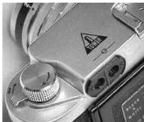
Камера Nissca 5L - TOWER 45 - окошко дальномера и визира, и ручка диоптрийной настройки.
