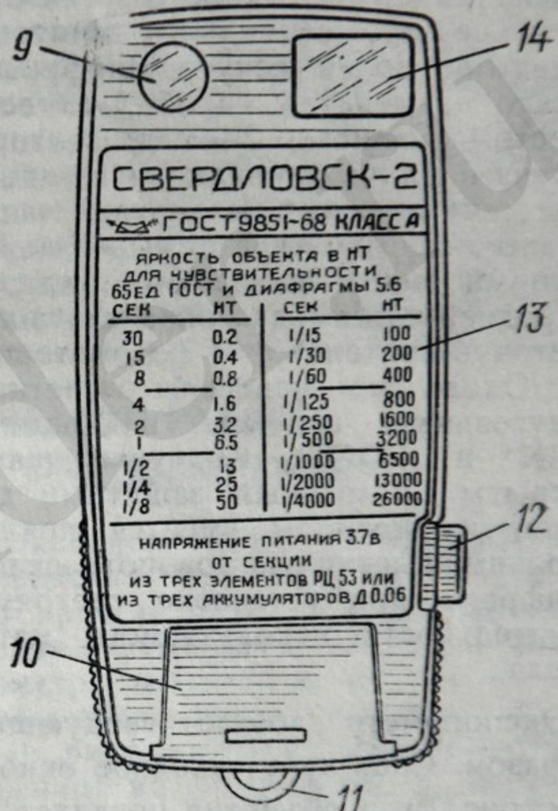
Рис. 2. Экспонометр. Вид сзади:
