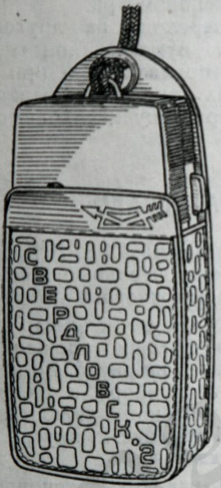
Рис. 5. Экспонометр в футляре
