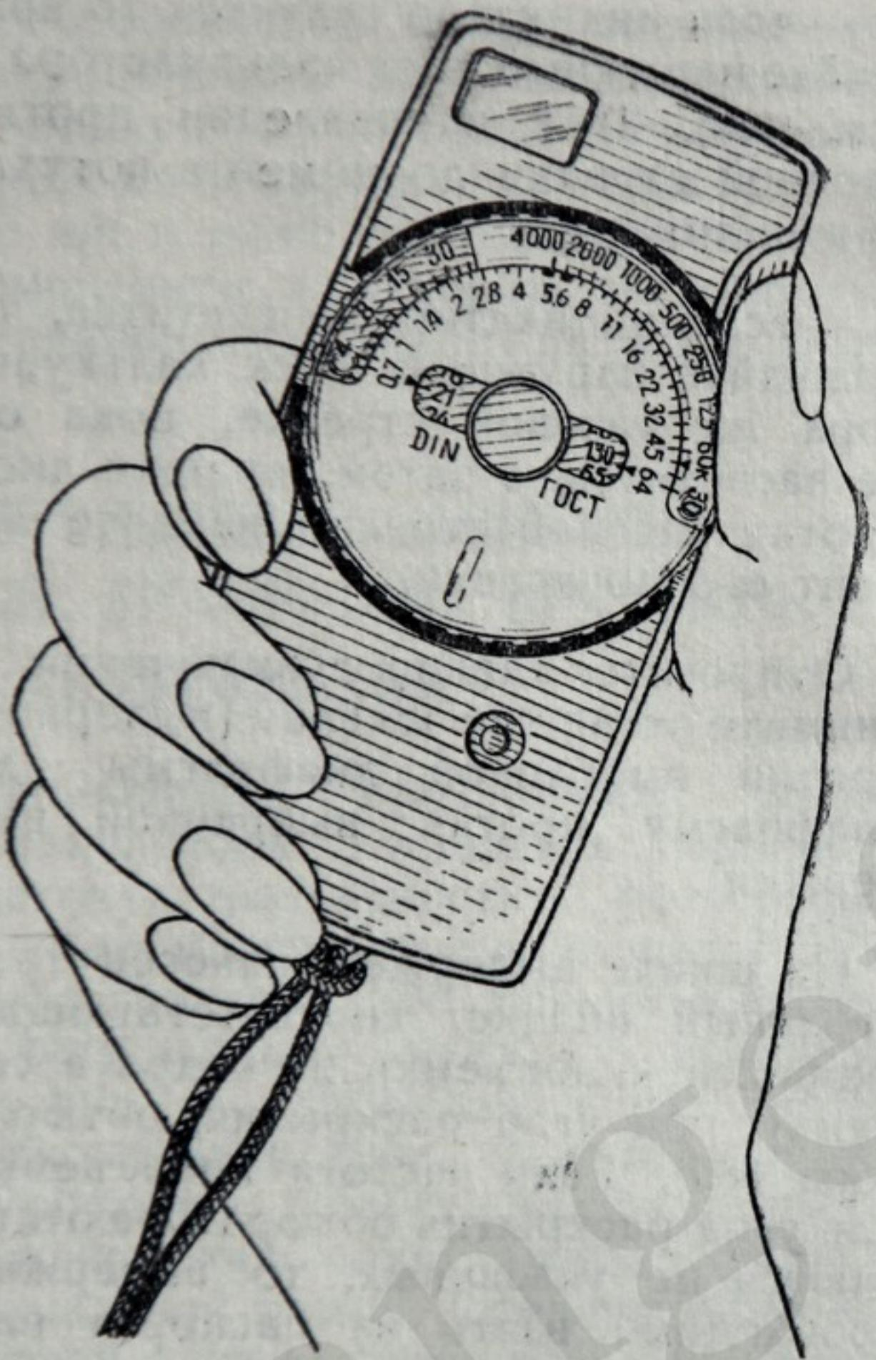
Рис. 3. Положение экспонометра
