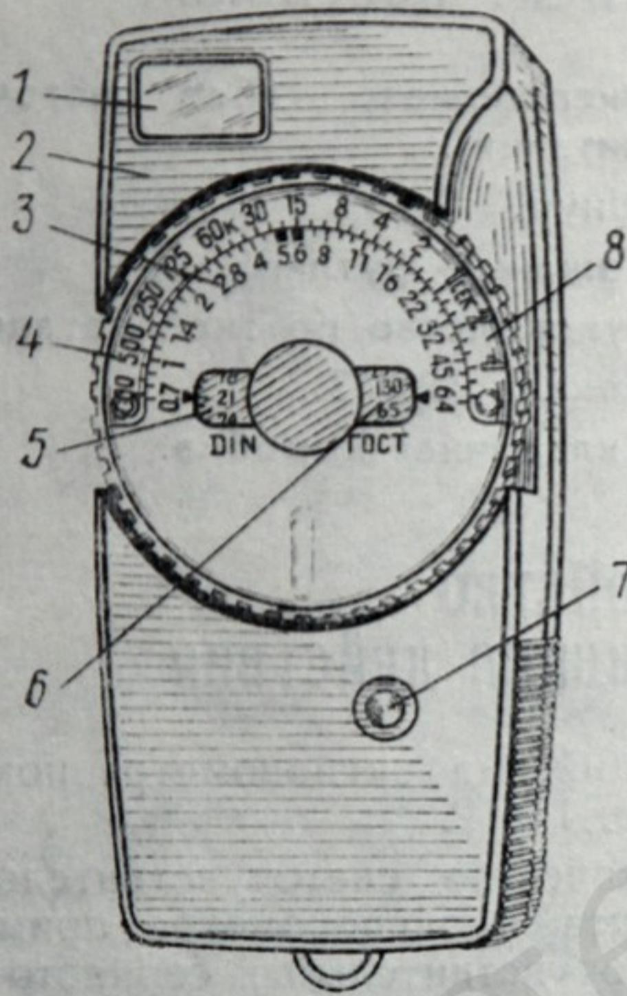
Рис. 1. Экспонометр. Вид спереди:
