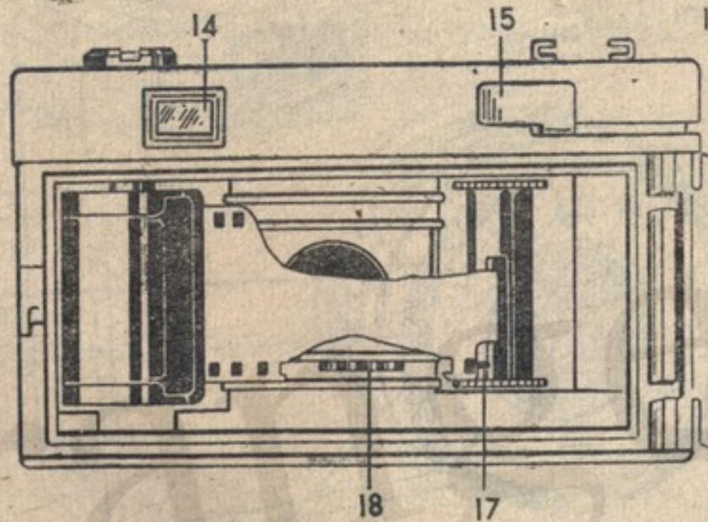
Рис. 2. Фотоаппарат с открытой задней крышкой
