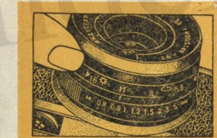
6.1.1. Установите поворотом кольца значение диафрагмы объектива. Для оперативной установки значения диафрагмы на кольце нанесены символы условий съемки.
