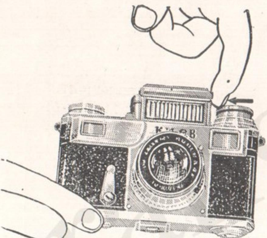
Рис. 33. Открывание крышки экспонометра.
