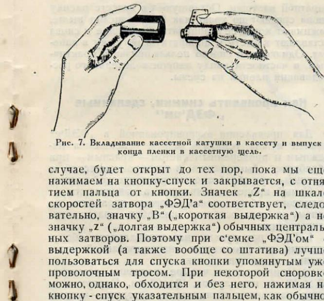
Рис. 7. Вкладывание кассетной катушки в кассету и выпуск конца пленки в кассетную щель.
