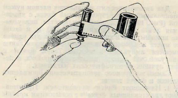
Рис. 9. Зажимание обрезанного конца пленки в аппаратной катушке.
