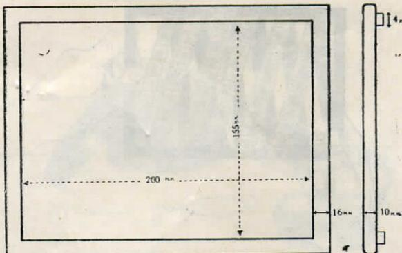
Рис. 17. Размерный чертеж рамочки для проявления пленки.
