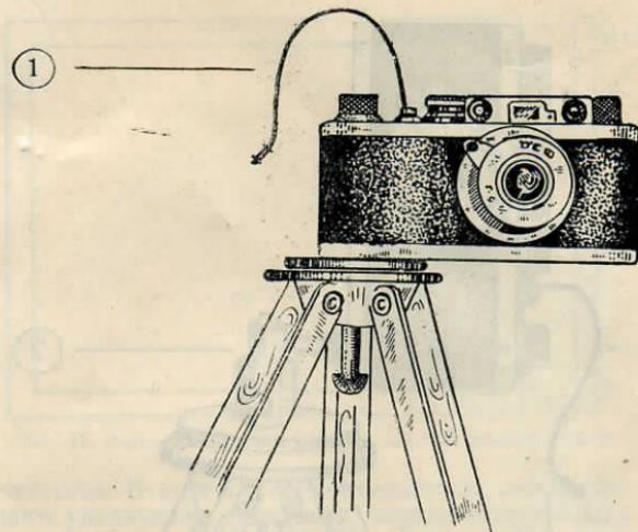
Рис. 15. Положение аппарата при съёмке со штатива на горизонтальный формат. 1) Проволочный трос.
