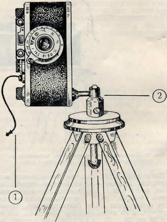
Рис. 17. Положение аппарата при съемке со штатива на вертикальный формат. 1) Проволочный трос. 2) Штативная головка.
