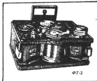
"ФТ-2" - рассчитан на нормальную 35-мм перфорированную пленку в специальных кассетах без обратной перемотки. Размер кадра 24x110 мм. Объектив - "Индустар-50", постоянно задиафрагмированный до значения 5, фокусное расстояние - 52 мм. Выдержки: 1/100, 1/200, 1/400 сек. (изменяется скорость поворота объектива). Видоискатель - рамочный откидной. Корпус - металлический "ящичной" формы. Имеется уровень.
