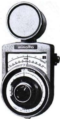
Рис. 84. Высококачественный измеритель цветовой температуры с тремя фотоприемниками.
