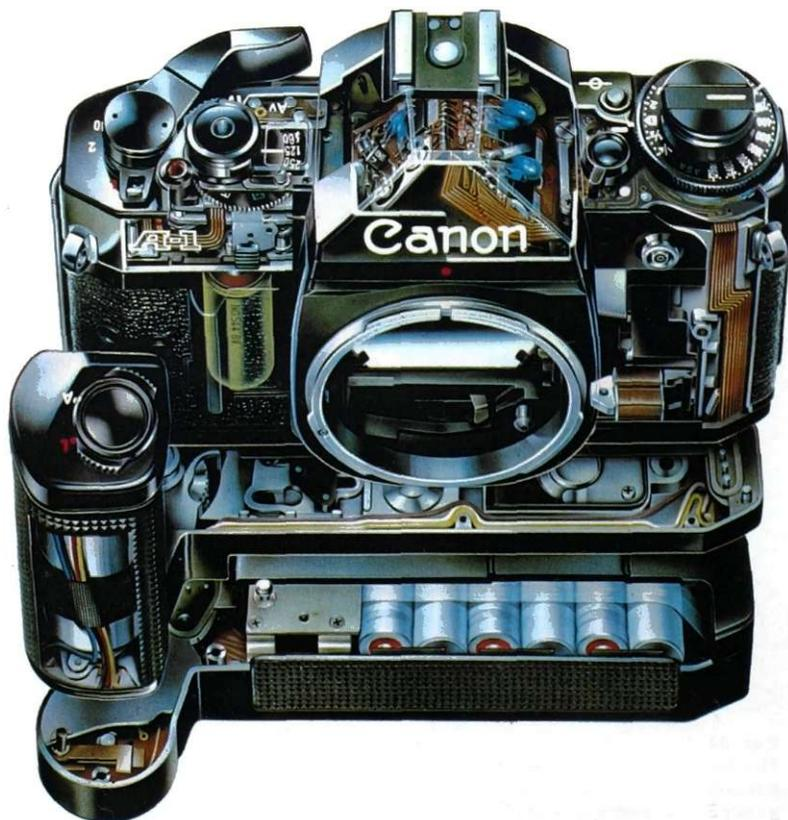
из хода лучей (поднимается вверх), открывая доступ световым лучам к пленке при открытом затворе. После экспонирования и закрытия затвора зеркало возвращается в первоначальное положение.
