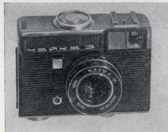
Полуформатный фотоаппарат «Чайка-3» предназначен для съемки на черно-белую и цветную фотопленки.
