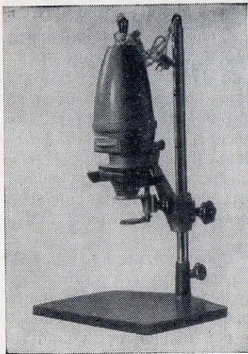
Пределы увеличения при расположении фотобумаги в плоскости экрана составляют от 2 до  $10^x$ . При повороте корпуса увеличителя в положение для проекции вне экрана максимальное увеличение достигает  $20^x$ .
