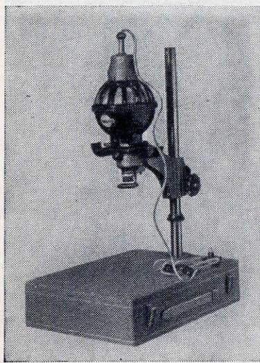
УПА-5 — портативный складной увеличитель вертикального типа с автоматической наводкой объектива на резкость. Проецирует изображение на горизонтально расположенный экран, являющийся одновременно крышкой футляра.
