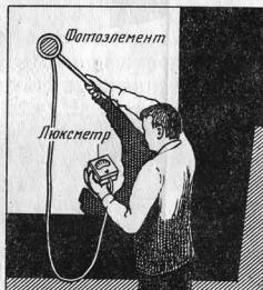
Рис. 141. Измерение освещенности экрана
