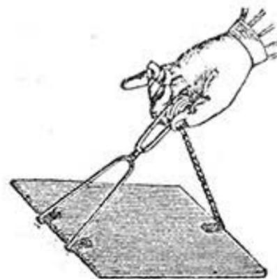
Рис. 148. Захват для пластинок.
