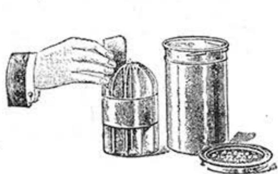
Рис. 137. Бак для проявления плоских пленок.
