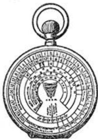
Рис. 158. Химический фотометр.
