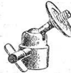
Рис. 110. Вращающаяся головка.
