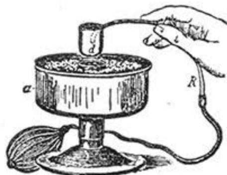
Рис. 184. Лампа для вдувания чистого порошка магния.
