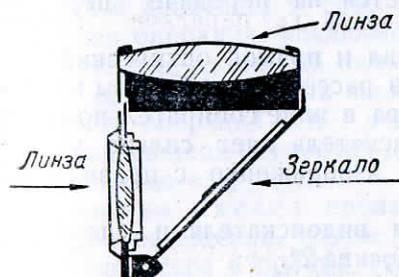
Рис. 23. Зеркальный видоискатель
