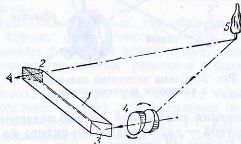
Рис. 20. Схема действия дальномера с клиновым компенсатором
