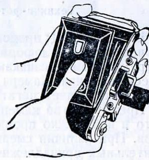
Рис. 46. Вторая операция закрывания камеры
