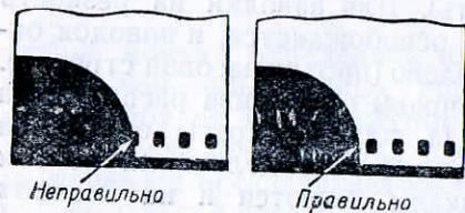
Рис. 51. Линия выреза не должна пересекать перфорационные отверстия
