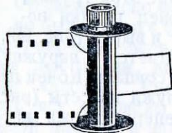
Рис. 92. Скрепление пленки с принимающей катушкой
