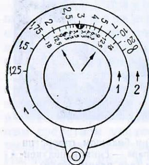
Рис. 15. Шкалы расстояний и глубины резкости
