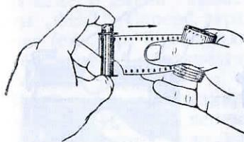
Рис. 87. Затягивание конца пленки
