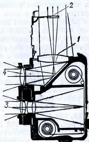
Рис. 35. Разрез камеры „Любитель“
