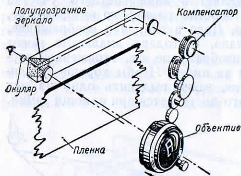
Рис. 21. Схема механизма дальномера с клиновым компенсатором
