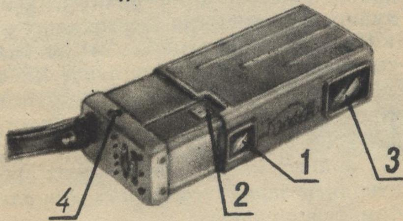
1—объектив; 2—спусковая кнопка; 3—видоискатель; 4—гнездо синхроконтакта.
