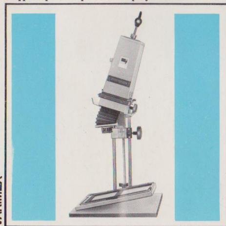
При снимках архитектуры или других выполненных аппаратом жесткой конструкции выступает часто смыкание линии. В таком случае следует головку фотоувеличителя установить под соответствующим углом, а стойку камеры с объективом наклонить. Угол уклона установить, наблюдая изображение.
