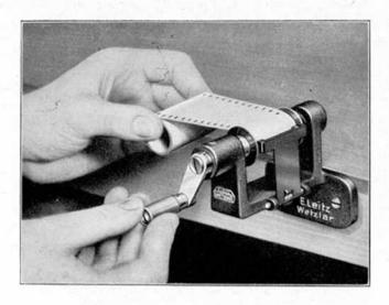
Fig. 28. Mechanical Winder
